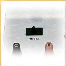
Disyuntor con rearme manual para evitar sobrecorrientes. Circuit-breaker with manual reset to prevent overcurrent. Disjoncteur à réarmement manuel pour éviter des surtensions.
