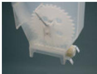
Sistema de dosificación Smartank: el mecanismo dosificador se encuentra integrado en el propio depósito, por lo que en caso de obstrucción o desgaste, puede ser reparado en pocos minutos por el propio usuario. El mecanismo se compone de un husillo, un rodamiento y un actuador de golpeo muy accesible.
