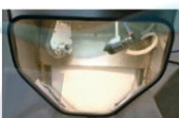
La arena almacenada en la tolva de la máquina es absorbida por la aspiración del Venturi y luego es inyectada a presión por la boquilla. Posteriormente vuelve a caer otra vez en la tolva.
