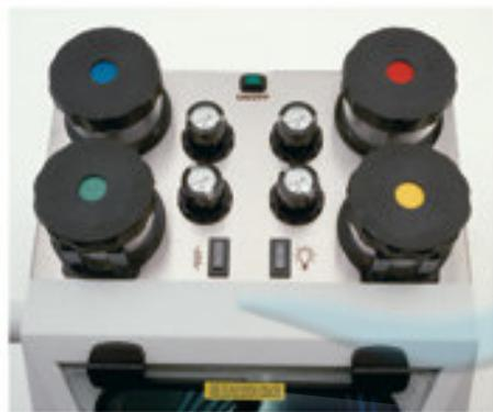
Cada uno de los vasos cuenta con su propio manóregulador y manómetro. En la parte central de la máquina se encuentran los mandos eléctricos: un interruptor de iluminación interior y un interruptor de las resistencias de calentamiento de la arena.
