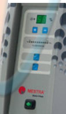
El panel de control de la unidad de aspiración Eolo Plus se encuentra situado en la parte frontal de la máquina, permitiendo un cómodo acceso a los mandos. Su concepto es de tipo sinóptico, por lo que luces, grafismo y botones se combinan para permitir un manejo muy intuitivo del aparato.
