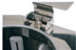
La puerta de acceso al interior de la cámara de polimerización se encuentra situada en la parte superior del aparato. La accesibilidad es completa. El interior de la cámara se ilumina mediante lámparas de dos tonalidades distintas.
