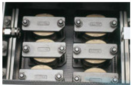
La amplia capacidad del compartimento, permite introducir 6bridas con dos muflas cada una.
