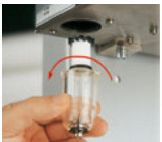
La sustitución o limpieza del elemento filtrante resulta sencilla. El acceso es inmediato, y no es necesario desmontar la máquina o emplear ningún tipo de herramienta.
