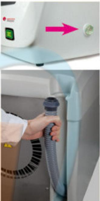
El vapor condensado se va acumulando en la parte inferior de la Cabina de Vaporización. Una práctica mirilla de nivel muestra cuándo el depósito se encuentra lleno, pudiéndose entonces vaciar a través de una cómoda manguera situada en la parte posterior. La operación se realiza en apenas unos segundos.
