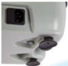
Las patas suponen un importante avance en la reducción de vibraciones. Tradicionalmente, las patas de un vibrador se diseñaban como ventosas para que quedasen fijadas a la mesa; o como pivotes huecos de gran flexibilidad. Los ingenieros de MESTRA consiguieron aunar ambos enfoques diseñando una patas con final en forma de ventosa y un tronco hueco. El resultado de tan ingeniosa solución es sorprendente: las vibraciones y ruido transmitidos a la mesa se reducen drásticamente.
