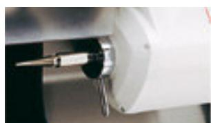
Motor potente 500 w y doble velocidad, diseñado para el box. Completamente cerrado y su eje aislado para evitar penetraciones de agua y pomez, incorpora extractores tipo palanca para facilitar el cambio de cepillos.
