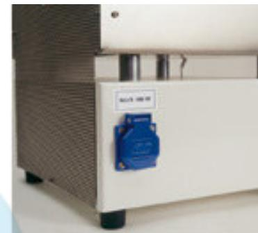
Una práctica toma de corriente permite el funcionamiento sincronizado del horno junto a una unidad de extracción. Pudiéndose programar su desconexión automática entre los 75° C y los 850° C. Cuando la temperatura se encuentra por encima de los 850° C, el control desconecta automáticamente la alimentación de la toma.
