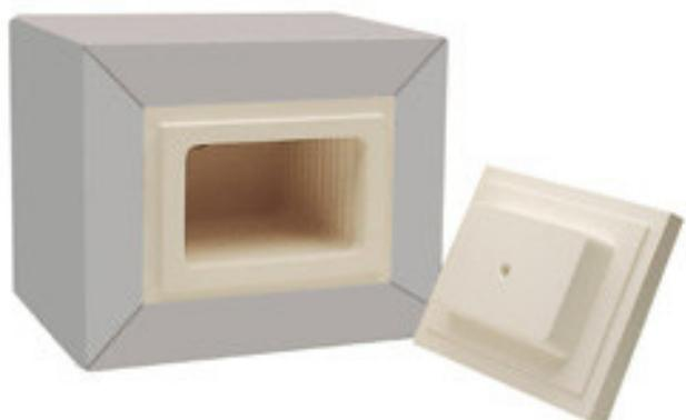
La mufla está fabricada en material cerámico con las resistencias de caldeo arrolladas a lo largo de las caras superior, inferior y laterales. Se consigue así una distribución de temperaturas uniforme en el interior. Las caras exteriores de la mufla se encuentran aisladas térmicamente con un recubrimiento de silicato de zirconio.
