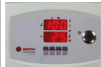
Control electrónico con display que muestra en todo momento la cantidad de polvo y agua expresada en gramos y mililitros; cuatro programas disponibles configurables por el usuario; rutina de calibración; tres modos de funcionamiento: sólo líquido, sólo polvo, polvo y líquido en proporción.
