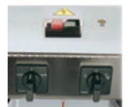
El Box incorpora 2 interruptores, más uno de seguridad. El 1º acciona el motor a 1.500 ó 3.000 r.p.m.. El 2º acciona luz o luz y aspiración. El interruptor de seguridad interrumpe la llegada de tensión al motor si ha habido un corte de suministro eléctrico teniendo que rearmararse manualmente.
