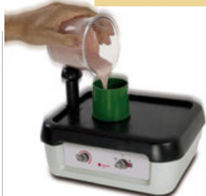
El soporte de vertido parte de un concepto totalmente innovador. Tradicionalmente, casi todos los fabricantes han diseñado este elemento compartiendo el mismo concepto básico: una bola de goma que se apoya en la mesa de vibración a través de un brazo giratorio escamoteable.
