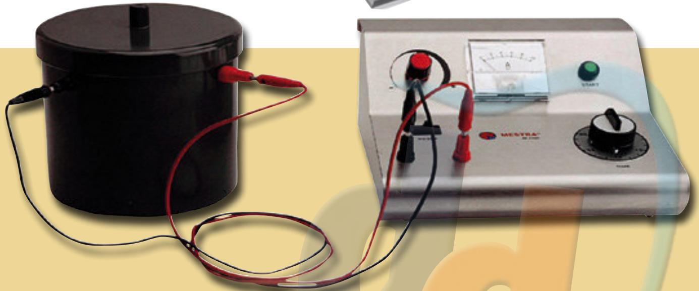
El pulidor electrolítico está especialmente diseñado para los laboratorios dentales. Se caracteriza por su fabricación en acero inoxidable y por la capacidad importante de la cuba. Se pueden pulir hasta tres esqueléticos simultáneamente. Dotada de un temporizador, se puede programar el pulido de 0 a 30'. Incluye un potenciómetro, un ampermímetro, una seguridad térmica y un dispositivo visual de funcionamiento. Aparato de concepción sobria y de gran eficacia.
