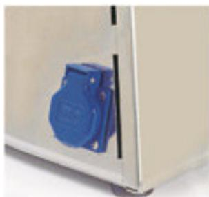
En la parte trasera de la máquina se encuentra una práctica toma de corriente a la que se puede conectar una unidad de aspiración exterior
