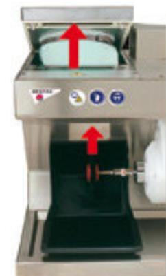
El sistema de aspiración se produce por depresión directa a saco de residuos.
