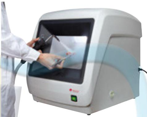
Fiable, segura y resistente. Con capacidad de cuba de 3 litros y presión de servicio de 3 atmósferas. La cuba está enteramente construida en Acero Inoxidable de alta calidad.
