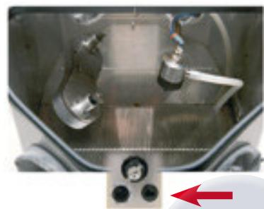
La arenadora con Pistola Estática Galaxy dispone de un botón para el soplado manual. De esta manera, -y orientando adecuadamente la boquilla- se facilitan los pequeños retoques de las piezas después del arenado automático.
