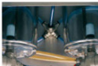
En el montaje del circuito neumático se han escogido elementos de alta gama. Destaca la precisión y suave accionamiento de la válvula distribuidora de 5 vías.
