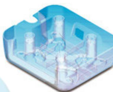
El diseño del chasis cuenta con innumerables nervios y refuerzos que lo dotan de una rigidez excepcional que nada tiene que envidiar a los fabricados en chapa de acero. Además, está construido en una sola pieza, lo que mejora la rigidez. A efectos prácticos esto se traduce en una exquisita suavidad de funcionamiento y baja transmisión de vibraciones y ruido.
