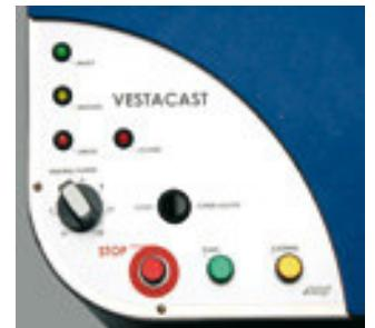
El cuadro de control es de tipo sinóptico permitiendo un manejo intuitivo. Tres botones de mando y un potenciómetro con el que se regula la potencia de fundido, son suficientes para realizar el colado. La temperatura de fusión puede llegar a alcanzar los 1750 °C. El estado del proceso se visualiza a través de cuatro lámparas indicadoras.
