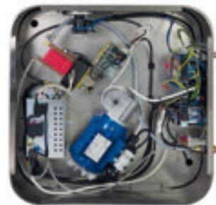
Los componentes empleados son de primera calidad y se encuentran ensamblados formando módulos autónomos. Con este concepto de diseño se simplifican enormemente las labores de mantenimiento: basta con soltar el módulo dañado y sustituirlo por otro nuevo, operación que puede llevarla a cabo cualquier Servicio Técnico con un coste reducido.
