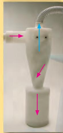
El principio de funcionamiento del Decantador de Polvo “Ciclón” es ingenioso: la corriente de aire aspirada circula por el interior del cuerpo de la máquina discurriendo a lo largo de un helicoidal. El peso propio del polvo le impide iniciar el movimiento ascendente hacia el tubo de salida, obligándole a caer al depósito.
